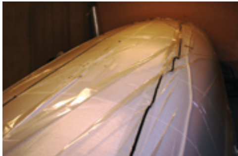
Skroget pakkes ind i plast med slanger til epoxy under. Under plasten skal der skabes vakuum.
