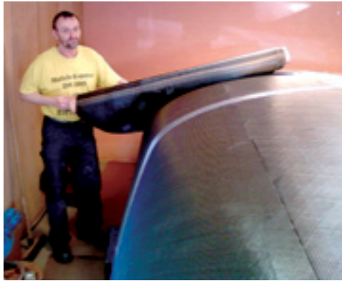
Tykkelse og retning på kulfibre er nøje beregnet – her lægges de planmæssigt på.
