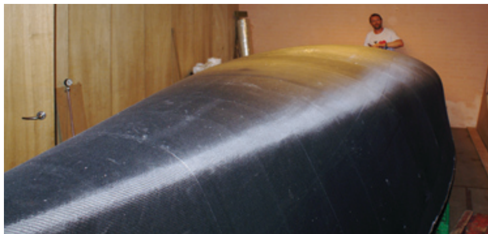
Ternens skrog er støbt færdigt udvendigt! Det vil sige – nu skal der spartles og slibes!
